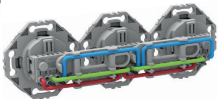
Boîte d'encastrement BBC étanche à l'air disponible en simple, double et triple poste. La boîte simple se décline en 2 profondeurs (40 et 50mm) pour répondre à tous les besoins de montage d'interrupteur et prise. Boîtes à griffes métalliques, pour cloisons creuses: plaque de plâtre, brique creuse... avec une large collerette d'appui. Accepte les gaines ICTA Ø16 / Ø20 / Ø25mm. Perçage scie cloche de Ø67-68mm.
